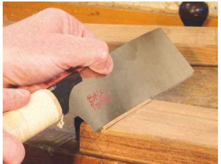
▲ Pic.3 Cutting the V-groove
